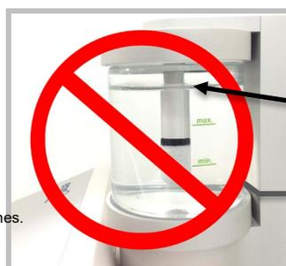
Fig. 5.2: Niveaux d'eau incorrects (pas entre min et max)
